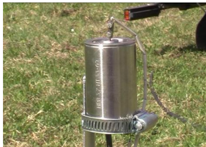
HPB 3,7 NT 33-60 «D» типоразмер 3,7 V; 1,3 Ah - тест батареи
