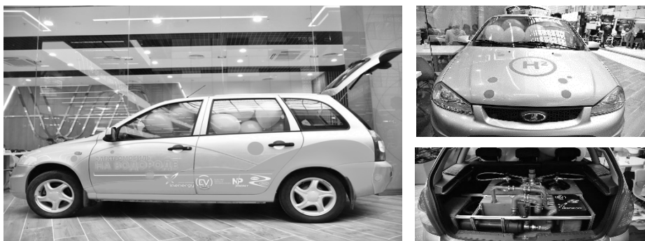
Первый российский электромобиль с ТЭ на базе LADA ELLADA – Электромобиль с прототипом энергоустановки на основе водородных топливных элементов
